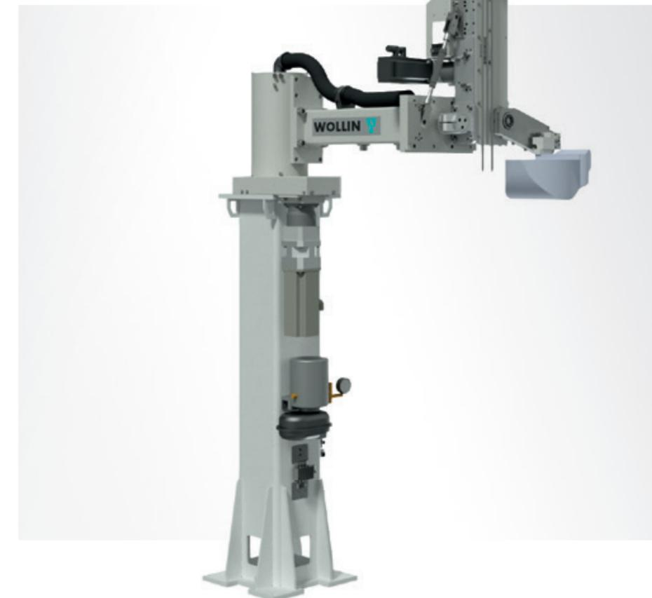
Les doseurs de métaux Wollin WL 1 - 4 ont été spécialement conçus pour l'alimentation automatique en métal des machines de coulée sous pression et des machines de coulée en coquille jusqu'à 80 kg de poids de puisage. Le montage peu encombrant s'effectue sur un support individuel, ne nécessitant aucune modification de la MAC ni du poteyeur.
